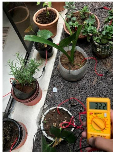
GRÁFICO 30. Planteras conectadas en serie. Elaboración propia.
