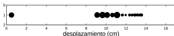
FIGURA 3.4: Simulación computacional de la primera dimensión de la electroforesis bidimensional en geles de agarosa: Los círculos corresponden a la posición final de los topoisómeros de dímeros anudados y superenrollados en un gel de agarosa al 0.4%, corrido a 30 V. El tamaño de cada círculo es proporcional a la fracción molar del topoisómero que representa.
