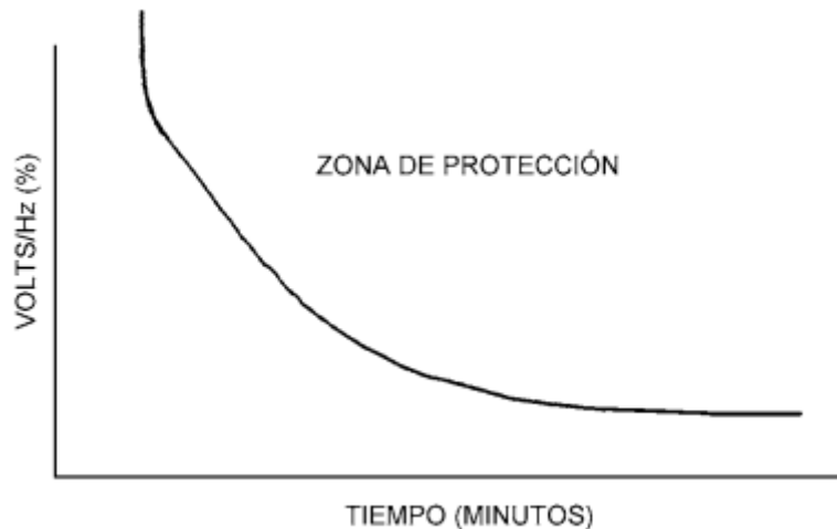
Figura 3.20: Característica típica del relé de tiempo inverso [7].
