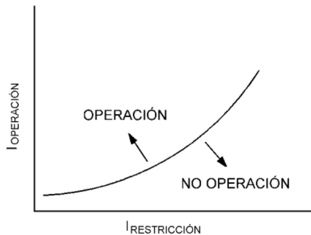
Figura 3.14: Relé diferencial de porcentaje de pendiente variable [7].
