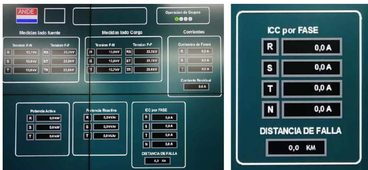
Figura 1 Visualización de datos del ETC desde el panel SCADA
