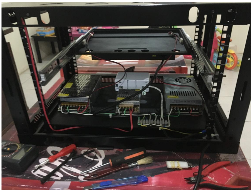
Ilustración 62: Clúster RPi's - Cableado de alimentación. Fuente: Elaboración propia.
