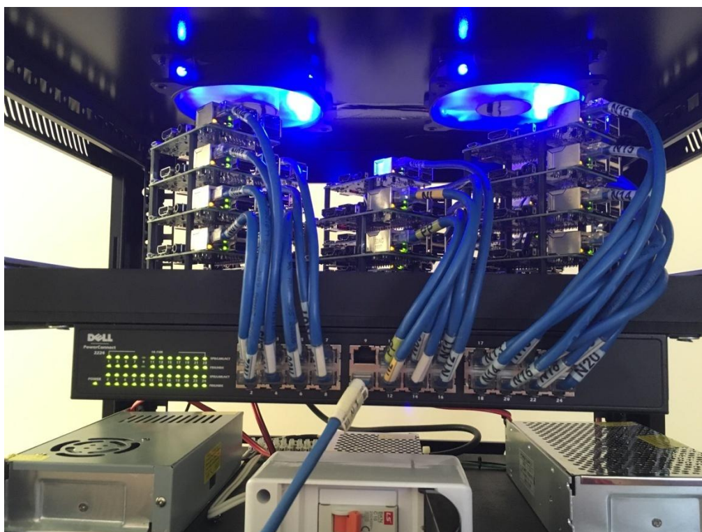
Ilustración 64: Clúster RPi's - Funcionamiento. Fuente: Elaboración propia.
