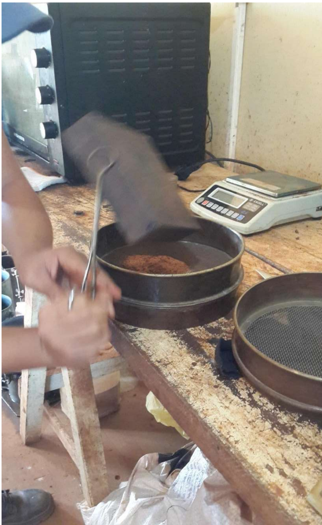
Ensayos de Granulometría.
