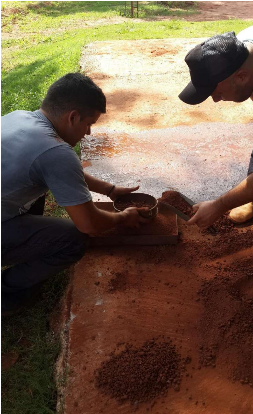
Selección para Ensayos de Granulometría.
