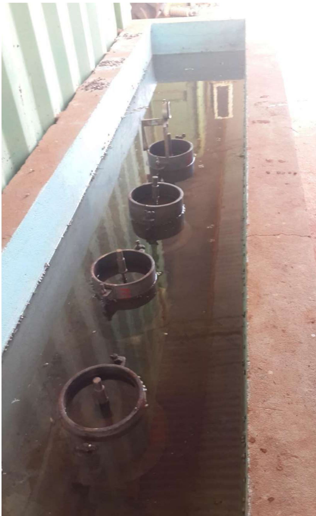
Inmersión en agua de las muestras de suelo cemento.
