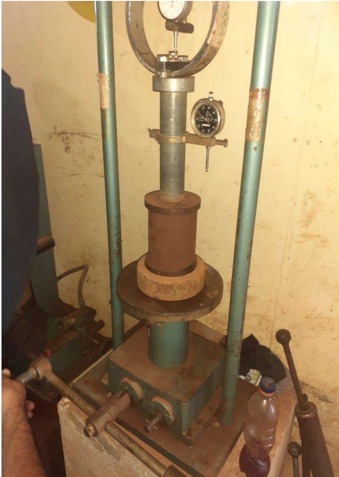
Ensayo de Compresión no confinada de suelo cemento.
