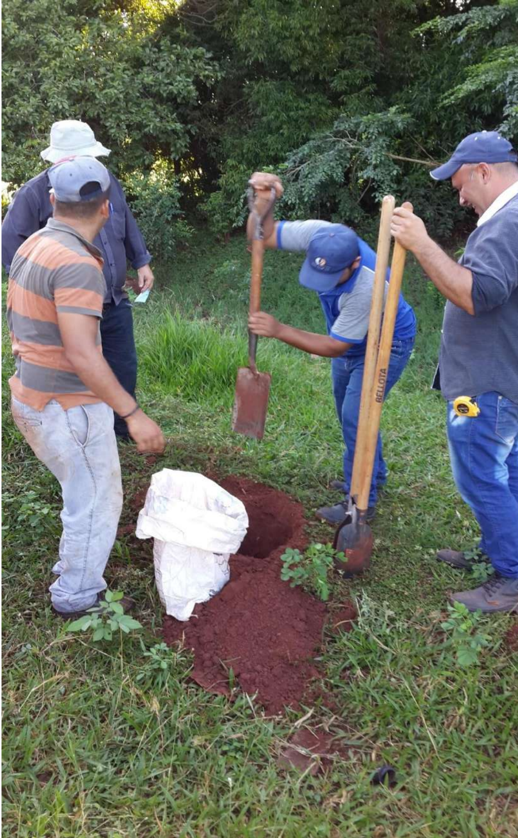
Extracción de muestras de suelo del lugar de préstamo 2.
