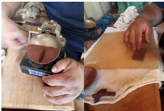
Ilustración 17 – Ensayo de Límite Líquido y Límite Plástico
