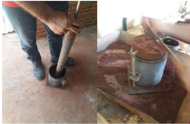
Ilustración 19 – Ensayo de CBR
