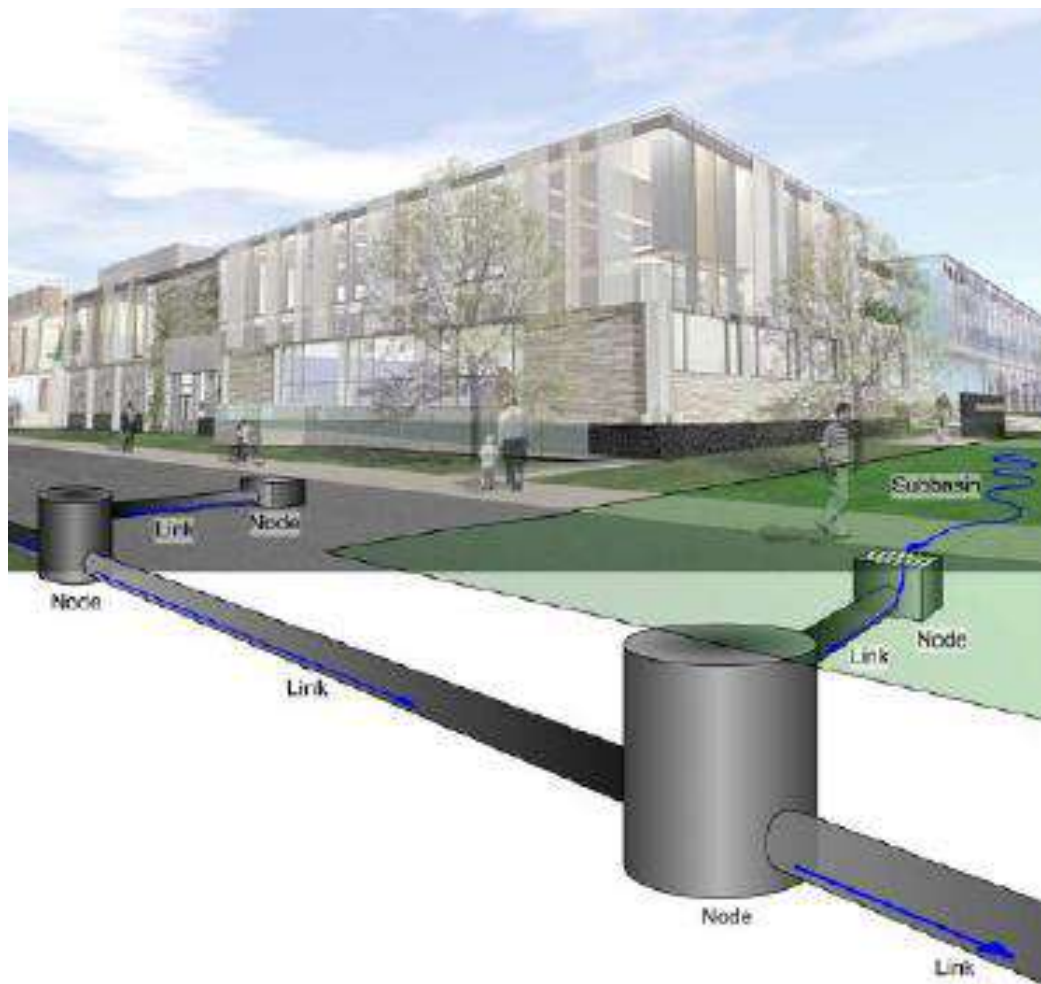
Figura 1: Representación de enlace de nodo de subcuenca para definir el modelo numérico que se analizó en SSA
