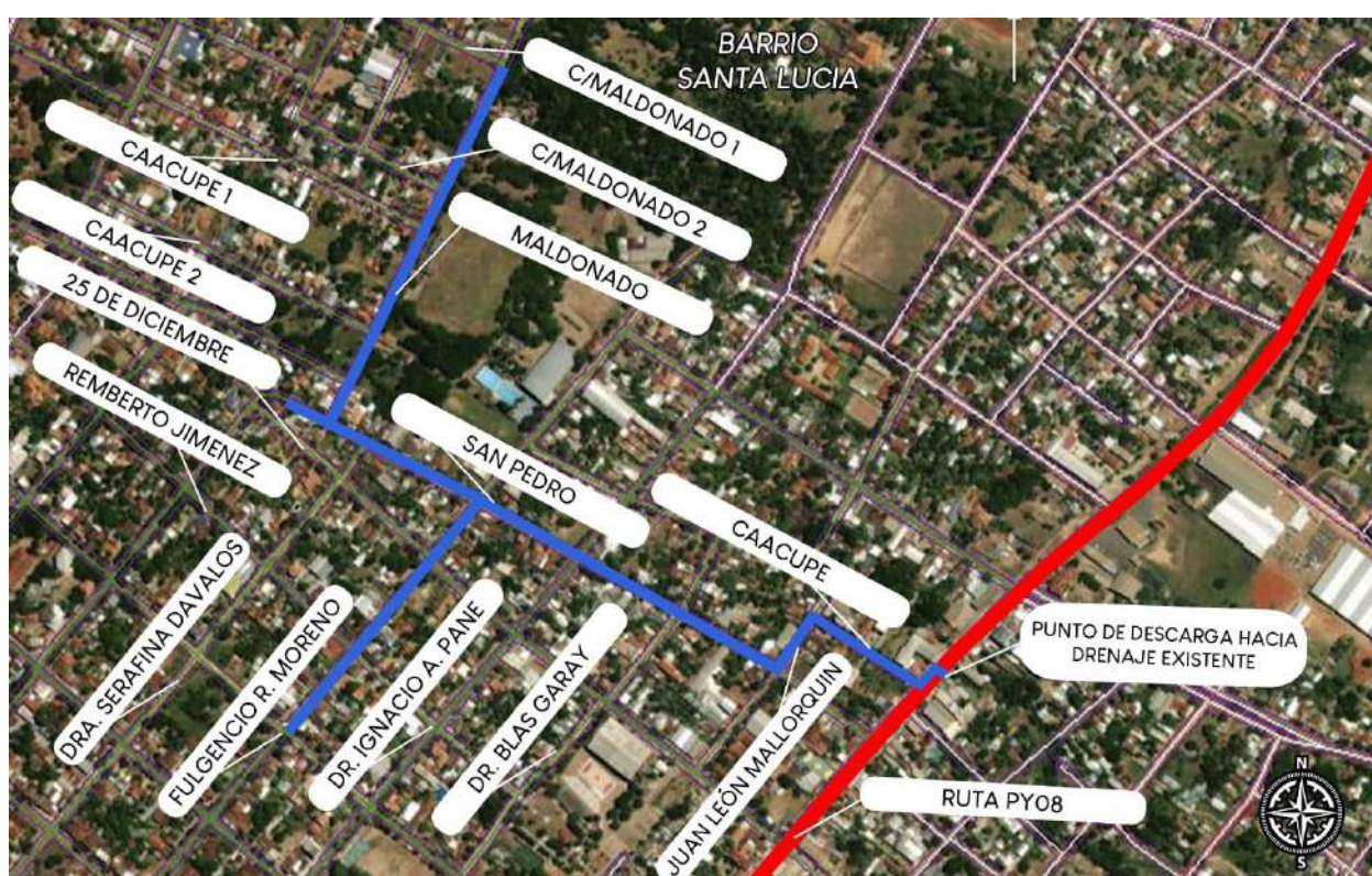
Figura 12: Ubicación de las líneas de alcantarillado propuesto
