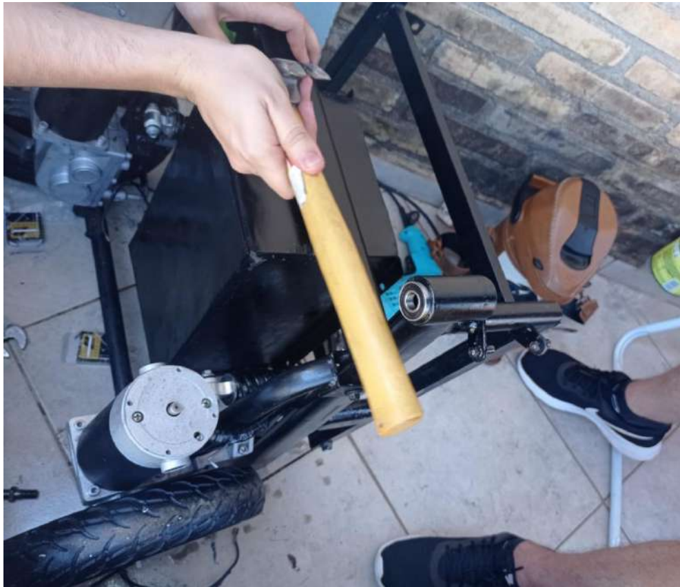
Figura 44. Colocación de rodamientos.
