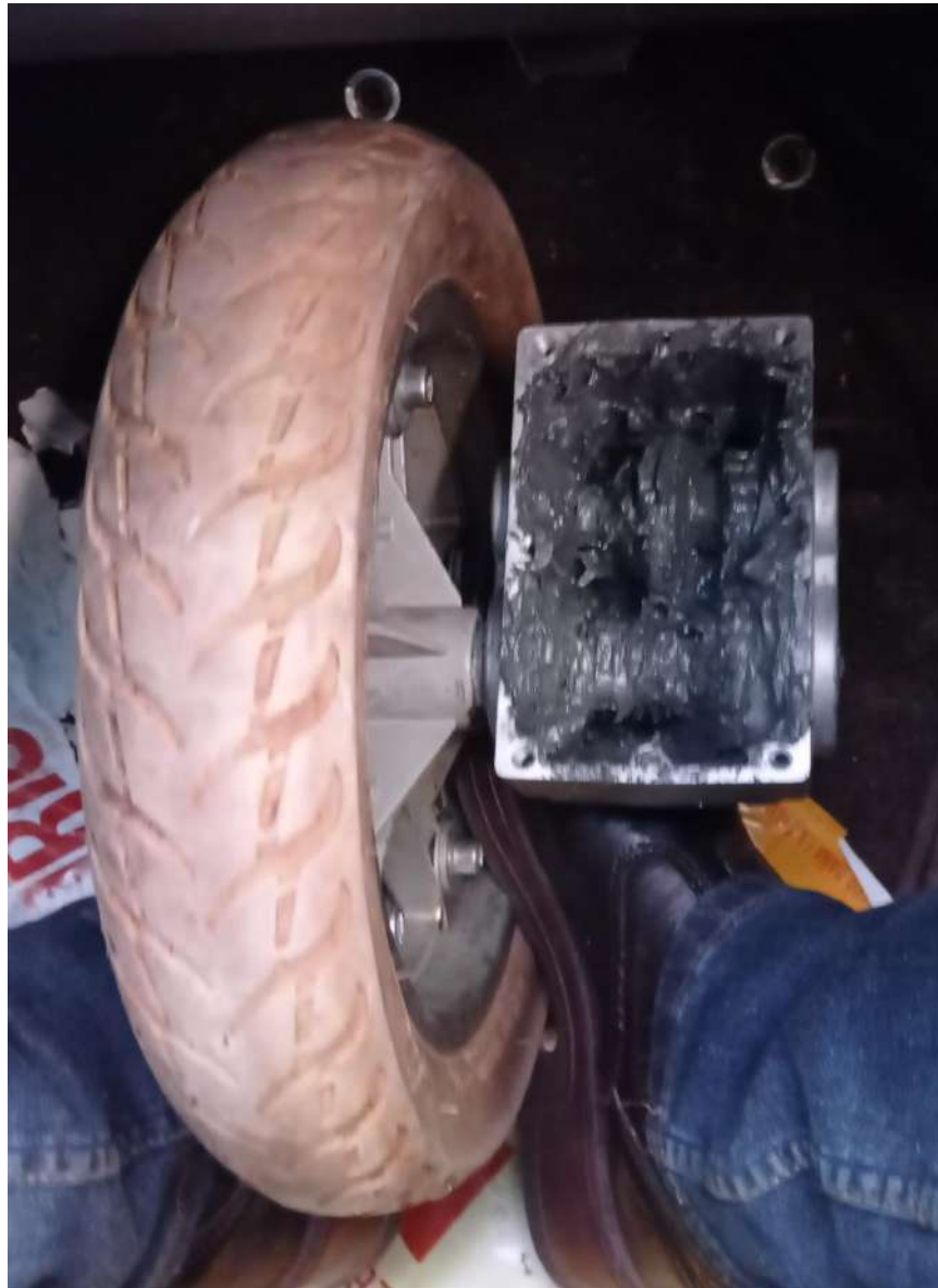
Figura 49. Mantenimiento de la caja reductora.
