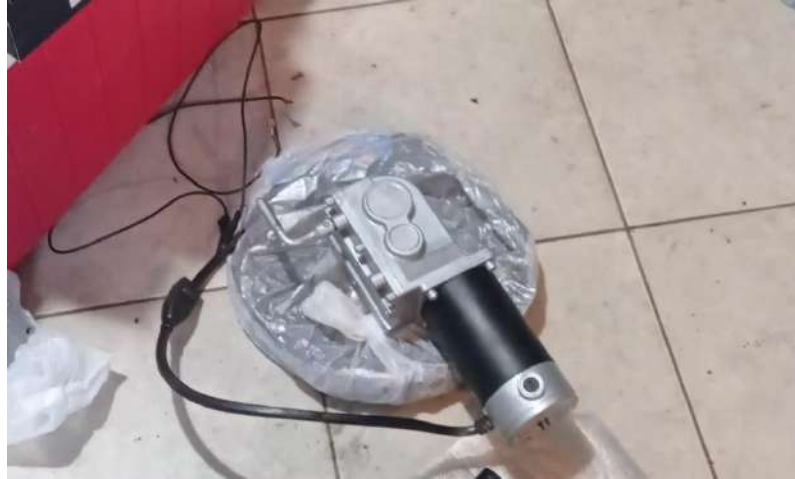
Figura 52. Ensamblaje de las partes del motor y reductor.
