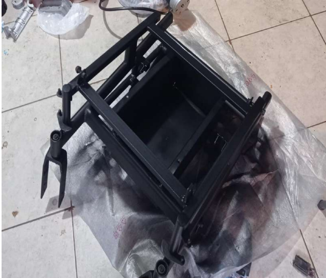
Figura 39. Estructura lijada y pintada.
