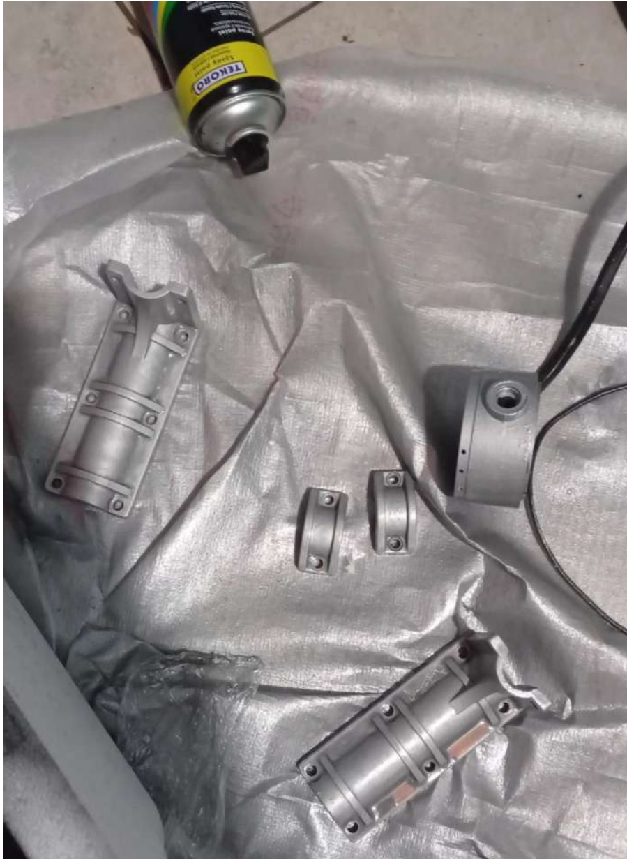
Figura 51. Pintura de componentes del motor y reductor.
