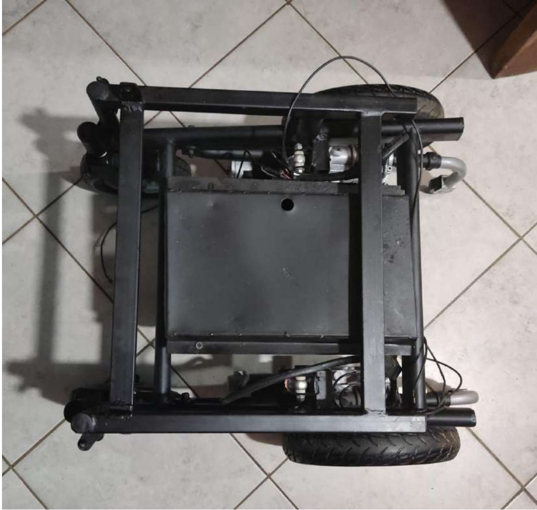
Figura 43. tapa de la caja de baterías.
