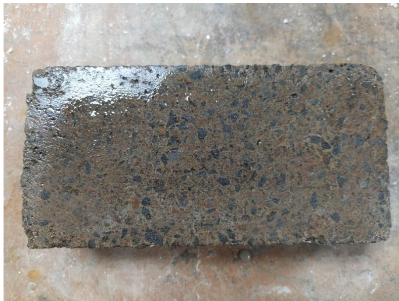
Figura 22. Muestra saturada para ensayo de absorción. Fuente: Elaboración propia.
