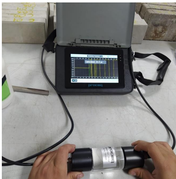
Figura 17. Calibración de equipo Proceq Pundit para ensayo de Ultrasonido Fuente: Elaboración propia.
