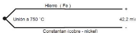
Figura 2. 9: Ejemplo de funcionamiento de Termocupla tipo J
