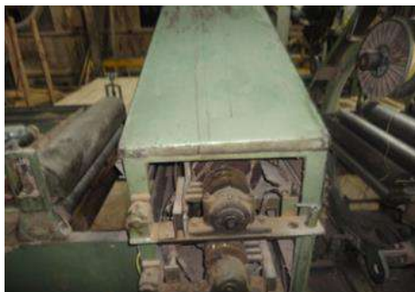
Figura B. 7: Sistema derretido de hilos con rodillos
