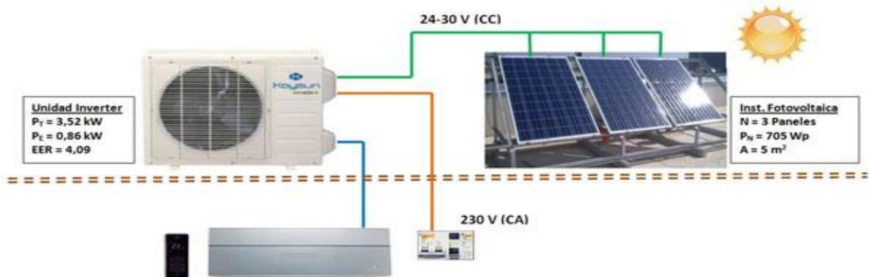
GRÁFICO 29. Módulo fotovoltaico para generar electricidad
