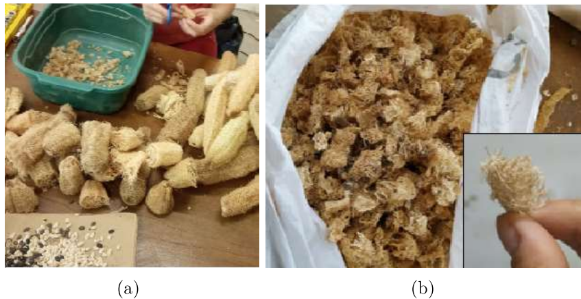
Figura 3.13: Preparación de la L. cylindrica : (a) como adquiridas y (b) esponjas en partículas.
