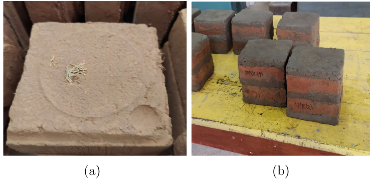
Figura 3.19: Preparación de las probetas para el ensayo de compresión: (a) bloque cortado, y (b) probetas terminadas.
