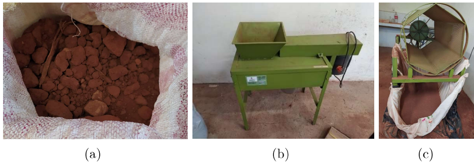
Figura 3.2: Preparación del suelo: (a) suelo como comprado, con terrones y material orgánico, (b) molino de tierra y (c) zaranda rotativa.
