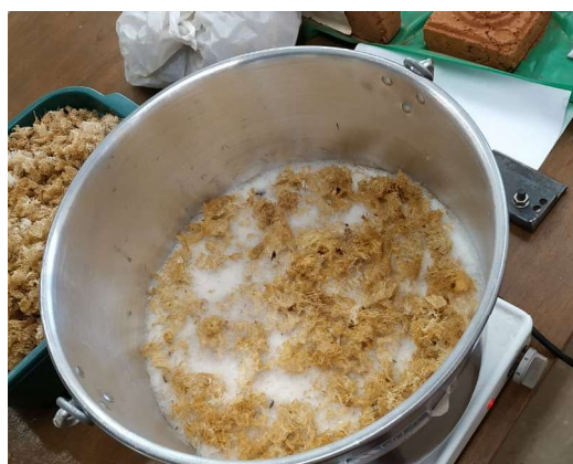
Figura 3.14: Tratamiento de la L. cylindrica con solución de NaOH.
