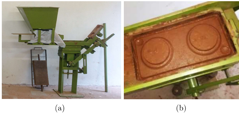
Figura 3.16: Fabricación de los bloques: (a) Prensa manual y (b) moldeo de los bloques.
