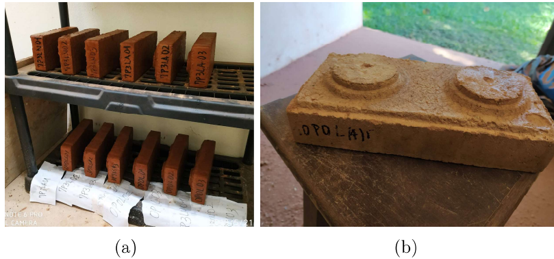
Figura 3.17: (a) Reposo y curado de bloques blandos y (b) producto final.
