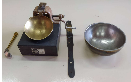
Figura 3.6: Máquina de Casagrande y utensilios para el ensayo de límites de Atterberg.
