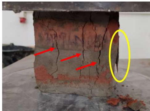
Figura 4.19: Patrón de fisuras típico en una cara de una probeta (flechas rojas), exfoliación (círculo amarillo).
