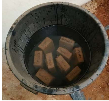
Figura 3.18: Bloques sumergidos completamente para el ensayo de absorción de agua.
