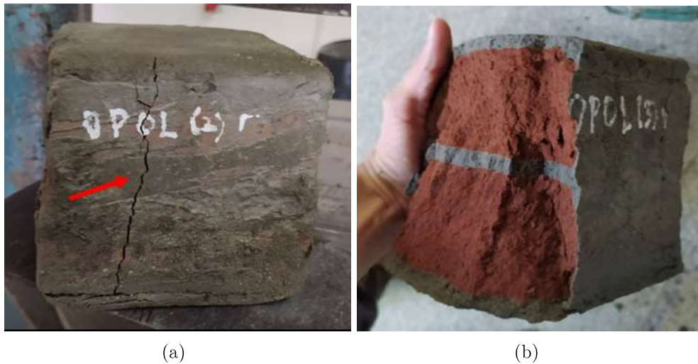
Figura 4.20: Probetas 0P0L (sin refuerzo): (a) patrón de fisuras típico (flecha roja), (b) superficie de rotura de aspecto uniforme.
