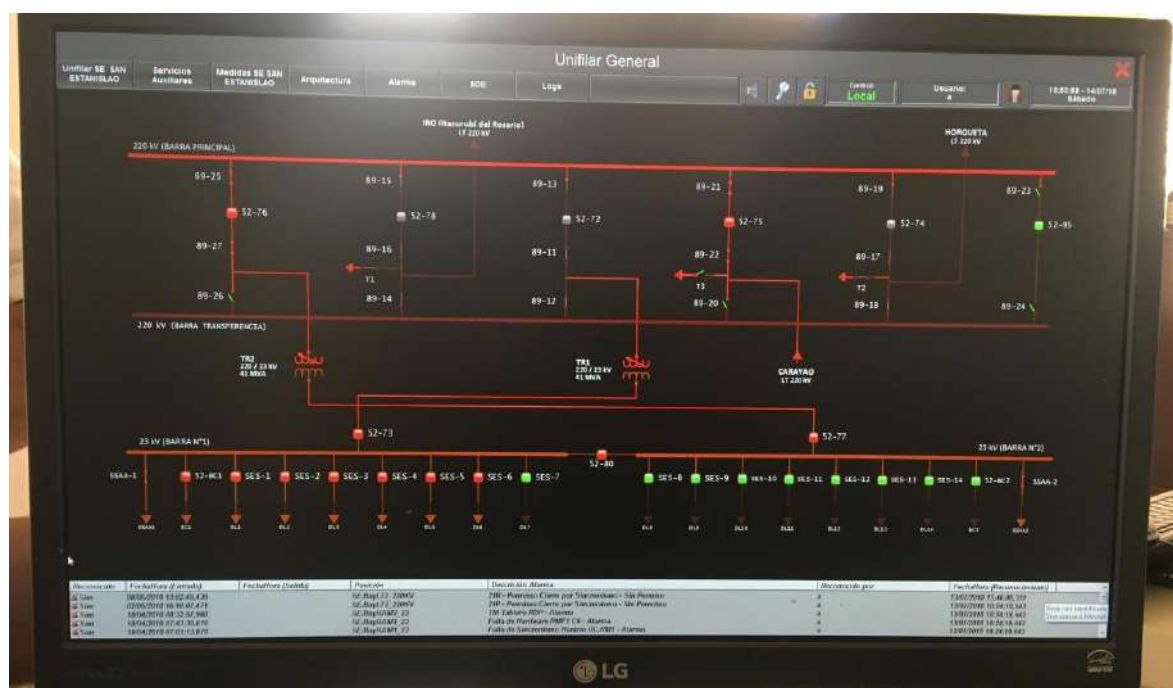
Figura 65: Esquema unifilar de la ES-SES, sala de control.
