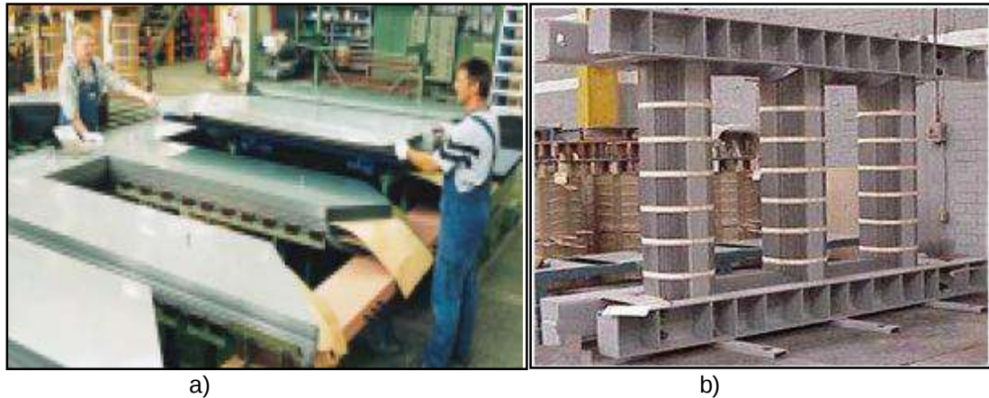
Figura 10: a) Ensamblaje "E", b) Núcleo terminado antes de la adición de bobinas.
