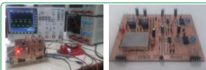
Figura 1: (Izq.) Plataforma experimental utilizada para realizar las mediciones. (Der.) Placa de control diseñada para el disparo de los SiC-MOSFET.
