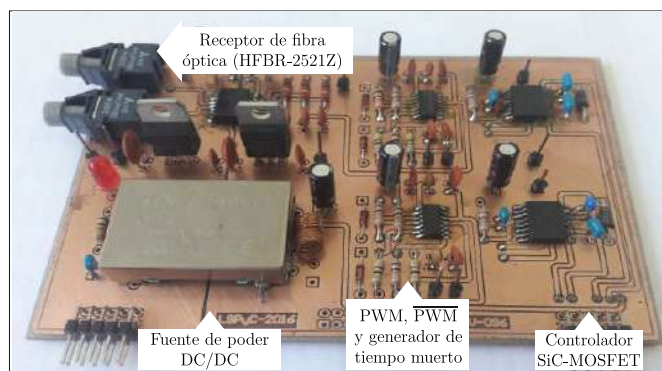
(b) Controlador Puente-H.
